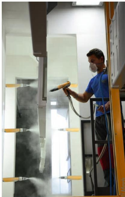
Die Automatikkabine ist zusätzlich mit einem Handbeschichterplatz und einer automatischen Konturerkennung ausgestattet.
