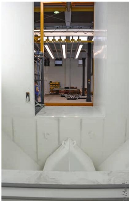
In der Automatikkabine erfolgt die Absaugung des Oversprays über den Bodenkanal, der bei Bedarf herausgenommen werden kann.
