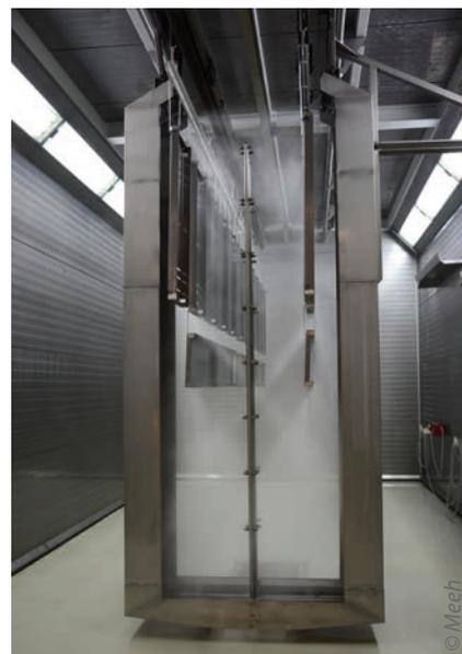
Die Luftsteuerung im Pulvereinbrennofen bietet die Möglichkeit, fünf Traversen mit fünf unterschiedlichen Farben zu vernetzen.
