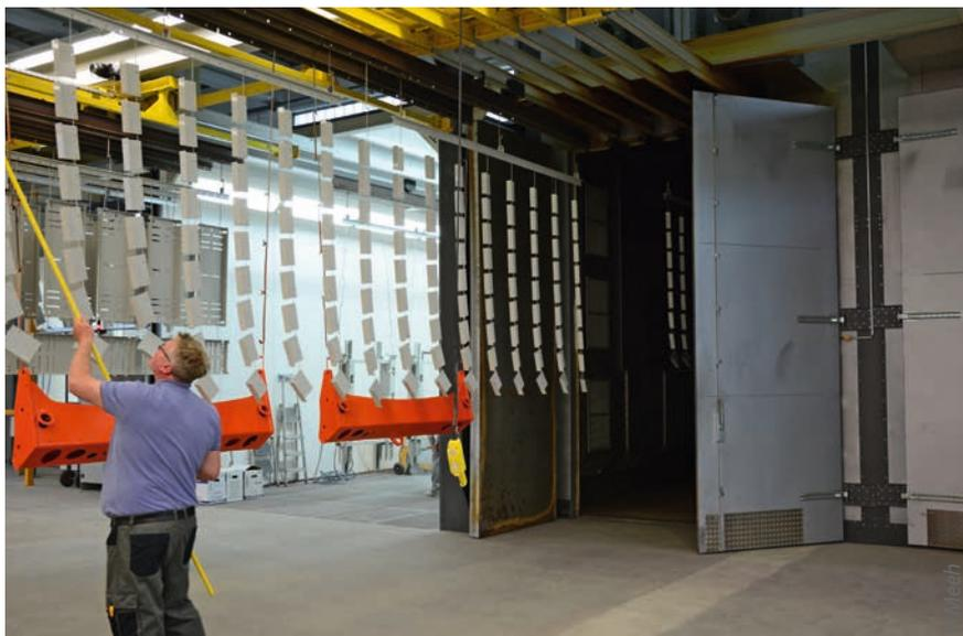
Die Luftsteuerung im Pulvereinbrennofen bietet die Möglichkeit, fünf Traversen mit fünf unterschiedlichen Farben zu vernetzen.
