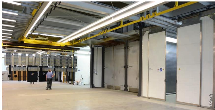
Die Querfahrbühne wird für den senkrechten Transport vor die Kabinen elektrisch und für den Quertransport in die Kabinen manuell bedient. Die Anlagentechnik von rechts nach links: Waschkabine, Haftwassertrockner, Einbrennofen, Pulverkabine und Nasslackierkabine.
